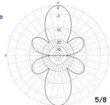
On peut voir ci-dessous les lobes de rayonnement sur les cinq bandes hautes, d'un fil résonant en demi onde sur 14 MHz (2x5,14m au coefficient de vélocité près). L'antenne fonctionne en onde entière sur 28 MHz et dans toutes les situations intermédiaires sur les autre bandes.
