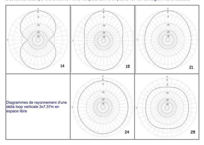
En espace libre l'antenne couvre toujours plus large que la Lévy; les gains sont comparables, et elle est supérieure à l'iso sur 360° sur 15 et 10m; avec la remarque cependant que sur 10m la mesure doit se faire pour un angle de tir de 13° ou plus.
