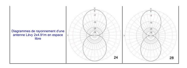
Le tableau ci-dessous compare le gain de cette Lévy à celui d'une antenne iso; entre 63 et 70% du temps on a moins de gain qu'avec une antenne iso.
